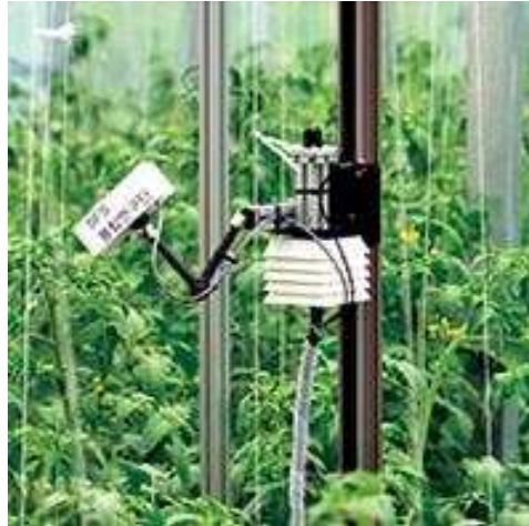
<그림 3-5> 엽온 및 대기환경 측정을 통한 증발산량 계측장비
