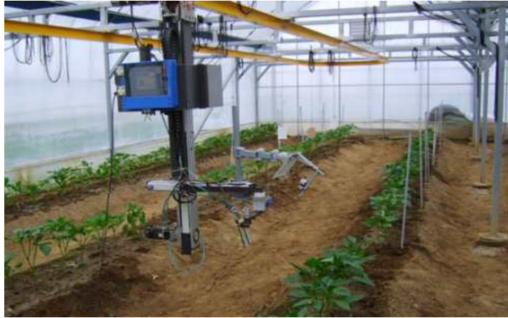
<그림 3-4> 지능형 농기계시스템 개발 사례 - 자동유인형 곤충방제 시스템
