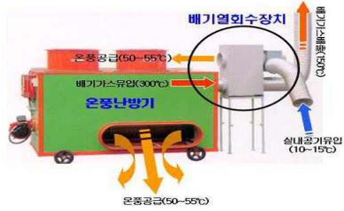
<그림 5-24> 열 회수형 환기장치(좌) 및 배기열 회수장치(우)
