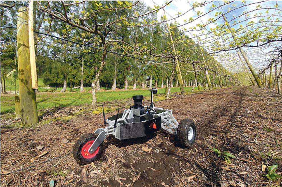
그림 20. 키위 과수원에서 예비실험 중인 배터리 구동식 자율 로봇 시스템
