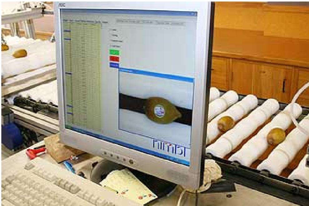
그림 19. Massey university에서 개발 중인 키위 선별 및 포장 장치
