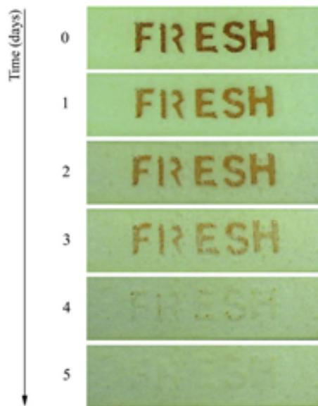
그림 11. Fading of the color in time-temperature indicator
