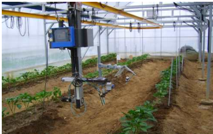
<그림 3-12> 지능형 농기계시스템 개발 사례 - 자동유인형 곤충방제 시스템
