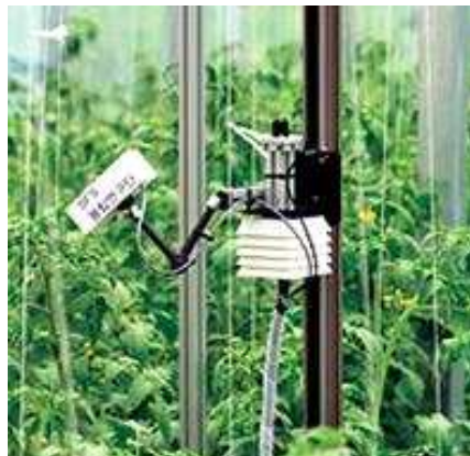
<그림 3-13> 엽온 및 대기환경 측정을 통한 증발산량 계측장비
